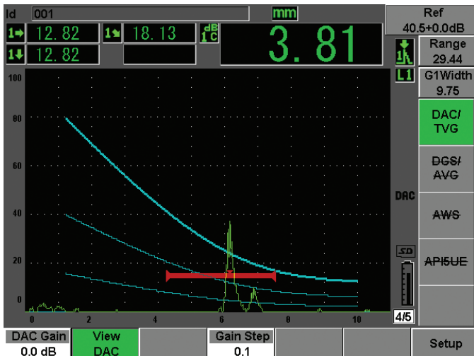
Funkcja dynamicznych krzywych DAC/TVG w EPOCH 600
