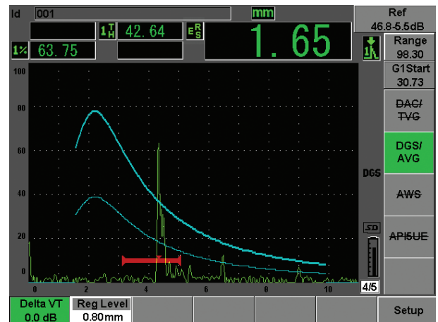
Funkcja Wbudowanych Wykresów DGS/AVG/OWR w EPOCH 600
