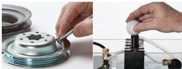
Ultraschalldickenmessungen sind genau, zuverlässig und reproduzierbar. Messwerte können sofort abgelesen werden, auch bei Messungen von nur einer Seite. Das Aufschneiden und Zerstören des Prüfteils ist nicht notwendig.
