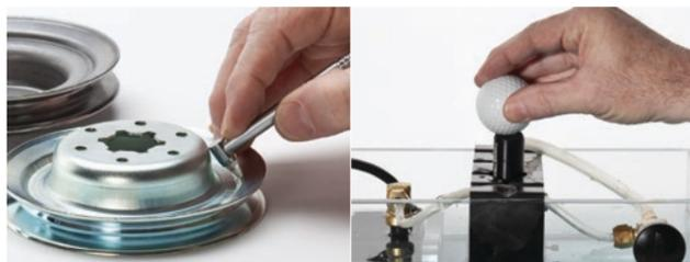
Les mesures d'épaisseur par ultrasons sont précises, fiables et reproductibles. Vous pouvez effectuer des mesures instantanées à partir d'un seul côté du matériau inspecté. Il n'est donc pas nécessaire de couper ou de détruire les pièces.
