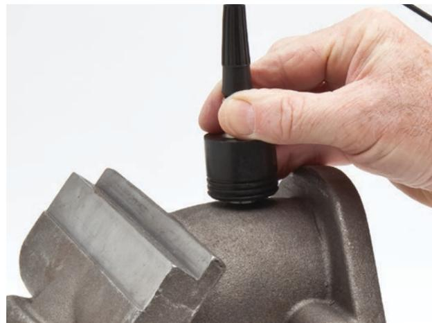
L'option logicielle de haute pénétration permet de mesurer de nombreuses pièces en fonte ou des matériaux d'atténuation acoustique.
