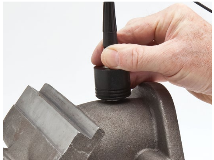
La maggior parte delle componenti in ghisa o in materiale a elevata attenuazione possono essere misurate con la funzione software opzionale High Penetration.
