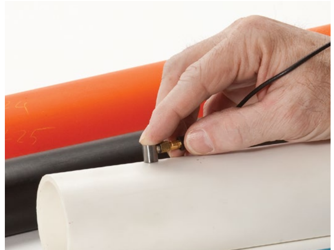
Permette di misurare lo spessore di numerosi materiali come la plastica, il metallo, la gomma, il vetro, la ceramica e i materiali compositi.
