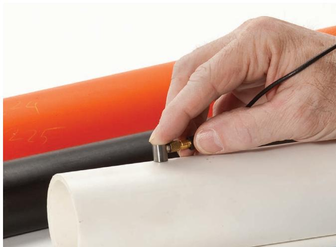
プラスチック、金属、ゴム、ガラス、セラミックおよび複合材の肉厚測定
