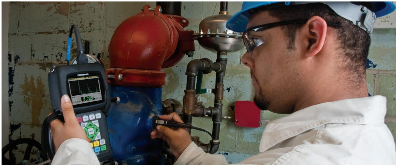
38DL PLUS は、超音波肉厚測定のおよそすべての検査用途に対応し、二振動子型探触子および一振動子型探触子のすべての探触子を使用できます。二振動子型探触子による内部腐食したパイプの減肉測定から、一振動子型探触子による薄い材料あるいは多層材料の正確な厚さ測定まで幅広い用途に使用可能です。
