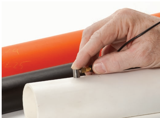
Mierzy grubość wielu materiałów jak: plastic, metal, guma, szkło, ceramika i kompozyty.
