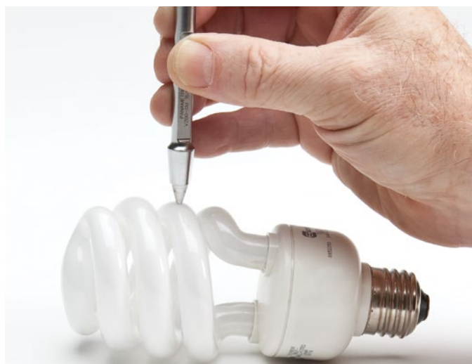
高分辨率软件选项可使用高达0.001毫米的分辨率进行厚度测量
