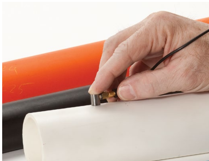
测量塑料、金属、橡胶、玻璃、陶瓷和复合材料等多种材料的厚度。
