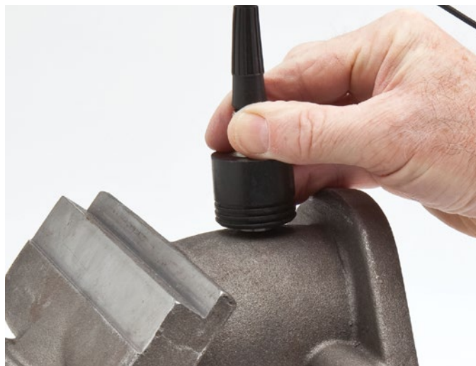
高穿透软件选项可以测量许多铸造金属部件或声速衰减性高的材料
