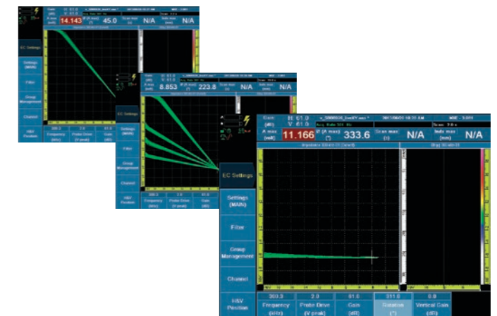
Ajuste el ángulo de fase en tiempo real con la rueda de ajuste del OmniScan. Es posible ajustar de la misma manera la ganancia, la ganancia vertical y el punto nulo (H/V).
