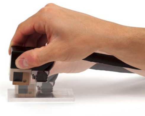
Génération de signaux d'entrefer avec la sonde ECA, de la même façon qu'avec la sonde ECT.
