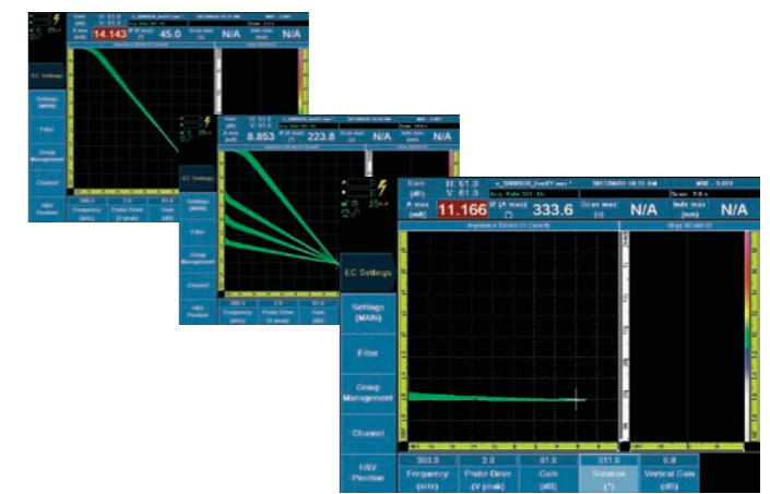
Ajustement de l'angle de phase en temps réel à l'aide de la molette OmniScan. Le gain, le gain vertical et le point zéro (H/V) peuvent être réglés de la même manière.
