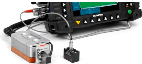
Collegando simultaneamente le sonde ECA e ECT si ottiene come risultato la migliore soluzione ispettiva, in quanto non viene richiesto l'arresto dell'ispezione e la riconfigurazione delle impostazioni dell'hardware.
