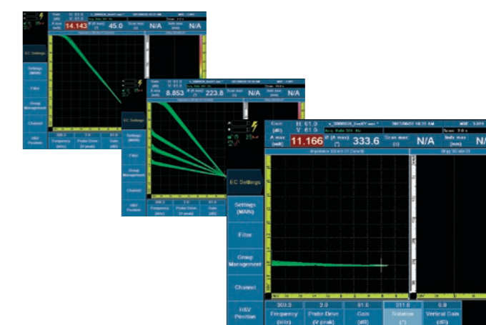
Regolazione dell'angolo di fase in tempo reale con la manopola di regolazione dell'OmniScan. I parametri Guadagno, Guadagno verticale e Punto Zero (Orizzontale-Verticale) possono essere regolati nella stessa maniera.
