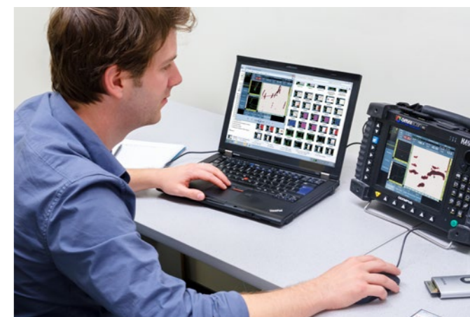
借助鼠标输入，用户可以快速有效地进行数据分析。借助紧凑型闪存（CF）卡的读卡器，用户可以将文件归档到PC机中。
