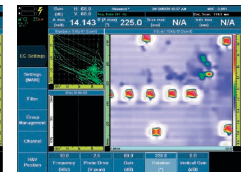
图中显示实际飞机蒙皮的腐蚀缺陷指示。不同颜色表明缺陷的不同深度。
