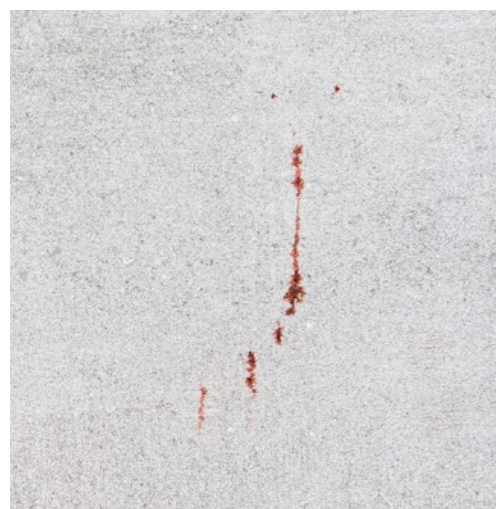
使用渗透法检测工件（红色渗透剂可见）
