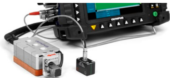
同时连接ECA and ECT探头是一种有效的工作方式，因为用户无需停下操作，重新配置硬件设置。
