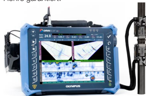
Der COBRA Scanner an einem Rohr mit 0,84 Zoll und zwei PA-Sensoren A15, Y-Adapter (Verteiler) und einem OmniScan MX2 16:64, der zwei PA-Gruppen anzeigt.
