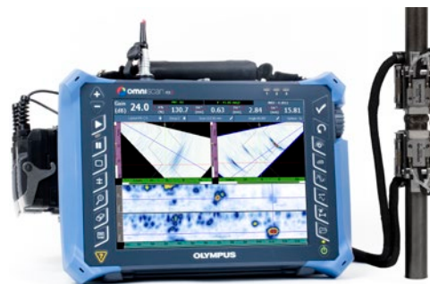
Escáner COBRA en una tubería de 0,84 pulg. con dos sondas PA A15, un adaptador Y (bifurcador) y un detector de defectos OmniScan MX2 16:64 mostrando dos grupos PA.
