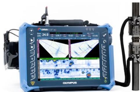
Lo scanner COBRA su una tubazione di 2,13 cm (0,84 in.) con due sonde A15 PA e un rilevatore di difetti OmniScan MX2 16:64 con due gruppi PA
