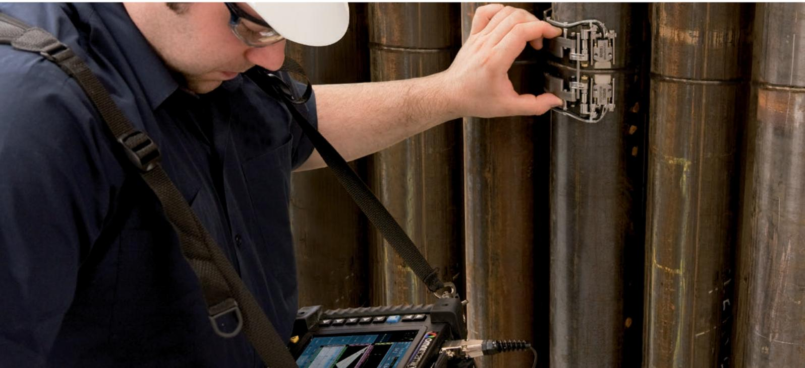
Lo scanner manuale COBRA™ combinato con il rilevatore di difetti OmniScan<sup>®</sup> PA viene usato per eseguire delle ispezioni di saldature circolari su tubazioni di diametro di dimensioni ridotte. Lo scanner COBRA può alloggiare fino a due sonde PA per le ispezioni di tubazioni con un diametro esterno compreso tra 2,13 cm (0,84 in.) e 11,43 cm (4,5 in.).
