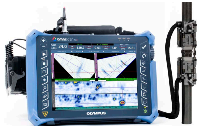
0.84 インチのパイプ検査に COBRA スキャナーを使用。2 つの A15 PA プロブ、Y-アダプター、スプリッター、OmniScan MX2 16:64 (2 つの PA グループを表示) を装着。
