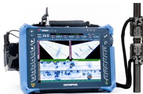
Сканер COBRA на трубе диам. 21 мм с двумя ФР-ПЭП А15, Y-адаптер (сплиттер) и дефектоскоп OmniScan MX2 16:64 с отображением двух ФР-групп.
