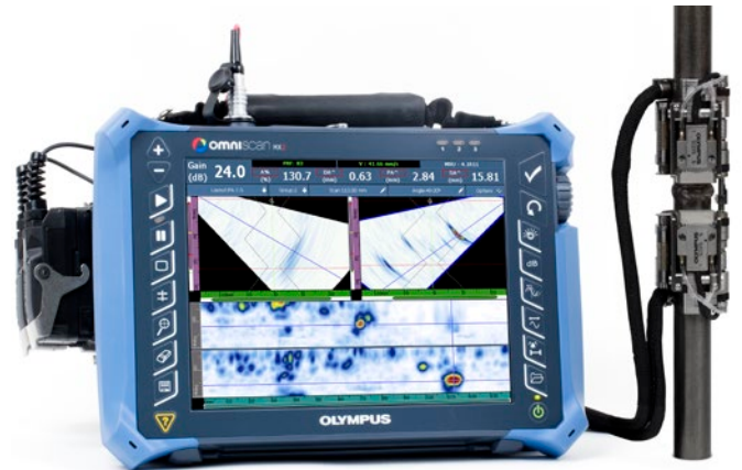
安装在21毫米管道上的装有两个A15 PA探头的COBRA扫查器，带有Y形适配器的分路器，显示两个PA组的OmniScan MX2 16:64探伤仪。
