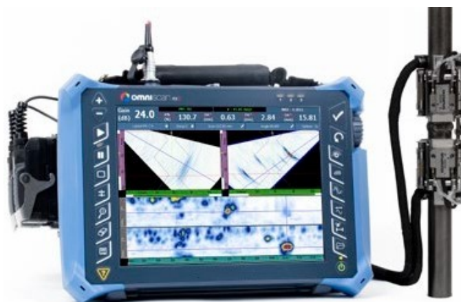
安装在21毫米管道上的装有两个A15 PA探头的COBRA扫查器，带有Y形适配器的分路器，显示两个PA组的OmniScan MX2 16:64探伤仪。
