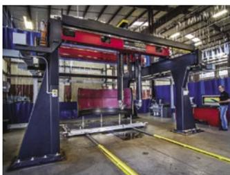
Zusammen mit RCLIB, DATALIB und einem leistungsstarken Überkopf-Scanner kann TomoView zur Prüfung von Komponenten mit komplexen Geometrien eingesetzt werden.
