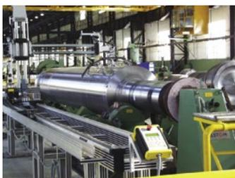
Mit der Erweiterung der Prüfdateien auf 2 GB und dem A-Bildeinzug bei Blendenüberschreitung ist es möglich, sehr große Teile in einem einzigen Durchgang zu prüfen.
