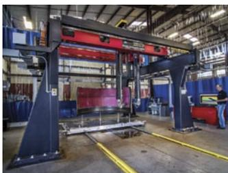
Potentes escáneres tipo «pórtico» pueden ser conectados a TomoView y a las bibliotecas para inspeccionar componentes de geometría compleja.
