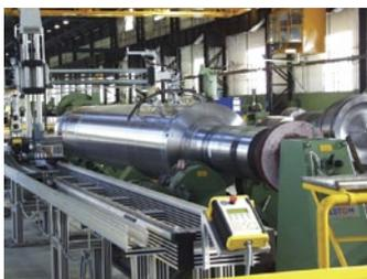
Gracias al tamaño incrementado de 2 GB en los archivos de datos, y a las funciones del A-scan condicional, las inspecciones en piezas de gran tamaño son posibles sin necesidad de efectuar adquisiciones múltiples.
