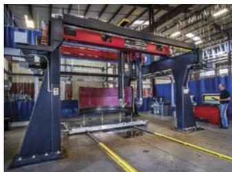
强大的悬架式扫查器可以与TomoView软件及上述的控制库、访问库相连接，对具有复杂几何形状的部件进行检测。
