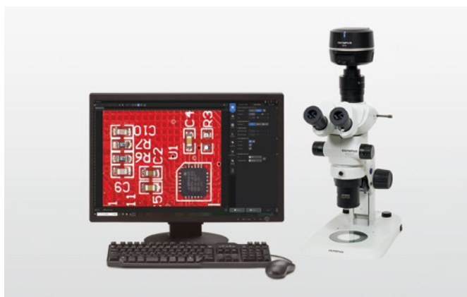
Mikroskop SZX7 s digitálním kamerovým systémem DP75
