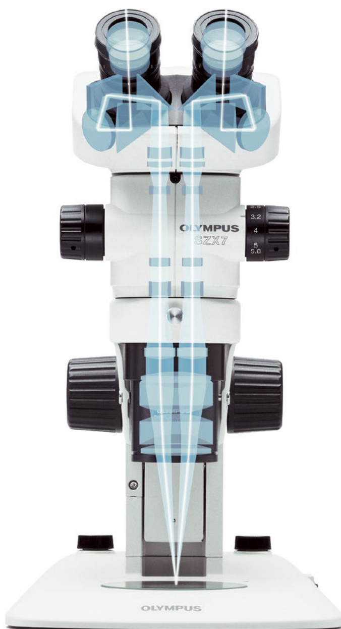
Optický systém Galilean má dvě nezávislé paralelní optické dráhy zoomu (pravou/levou), které vytvářejí ohnisko pomocí jediného objektivu. Systém umožňuje vysoký optický výkon i funkční modularitu.
