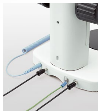
Připojení zemního vodiče (na zadní straně)
