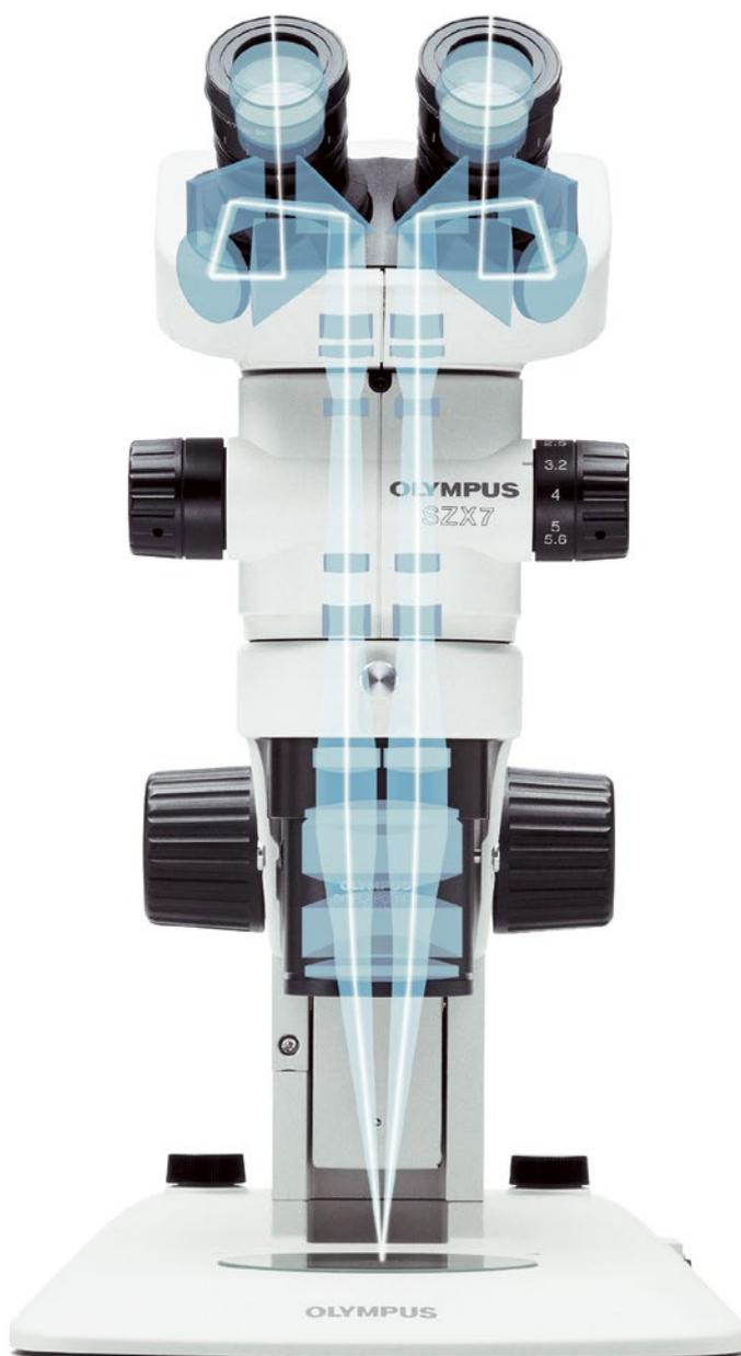
*Les composants optiques galiléens présentent deux trajets optiques (droit et gauche) indépendants et parallèles pour produire le point focal de l'objectif. Le système permet à la fois d'excellentes performances optiques et une grande modularité fonctionnelle.*
