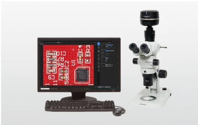
Microscópio SZX7 com sistema de câmera digital DP75
