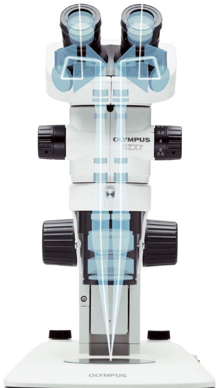
A óptica de Galileu apresenta dois caminhos ópticos independentes e paralelos (esquerdo/direito) para produzir o ponto focal com uma objetiva. O sistema permite alto desempenho óptico assim como modularidade funcional.
