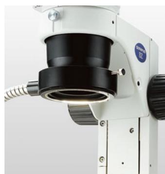
Sistema de fibra óptica de iluminação homogênea
