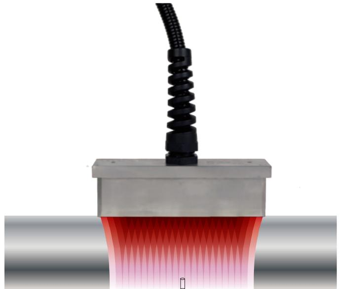
Las inspecciones *phased array* detectan los pequeños defectos con una variación no mayor de 2 dB entre dos leyes focales.
