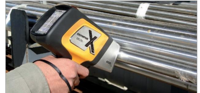
Der leistungsstarke DELTA RFA-Handanalysator maximiert Prüfgeschwindigkeit und Genauigkeit für Analysen von Legierungen und Reinmetallen, für Qualitätskontrolle und -sicherung, für Sicherheit und Instandhaltung.
