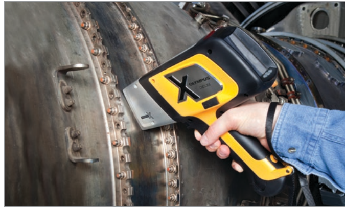
Análisis de correlación del fósforo (P) en acero de baja aleación con el analizador DELTA Premium SDD.
