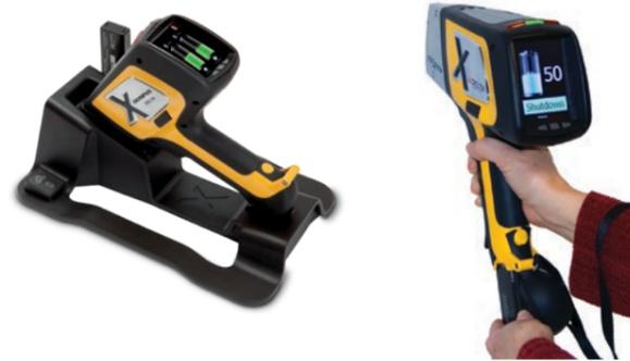
De conception unique, la station d'accueil DELTA permet de n'avoir jamais à éteindre l'analyseur. Elle charge la batterie de l'analyseur et la batterie de rechange et effectue une vérification périodique de l'étalonnage. Les appareils DELTA peuvent fonctionner sans interruption grâce à la batterie remplaçable à chaud\*.
