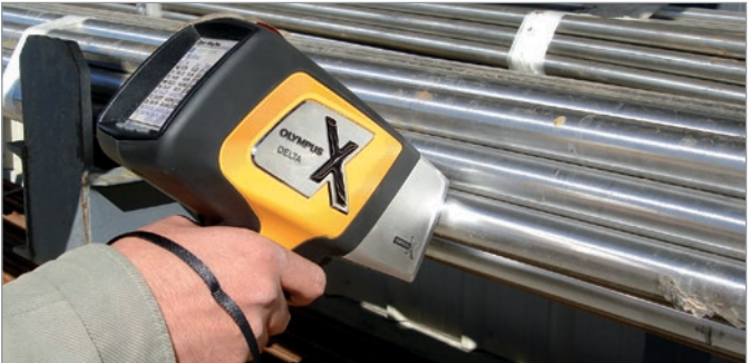
Il potente analizzatore XRF portatile DELTA massimizza la velocità e la precisione per l'identificazione di metalli e leghe, per il controllo e l'assicurazione qualità, e per la sicurezza e la manutenzione.
