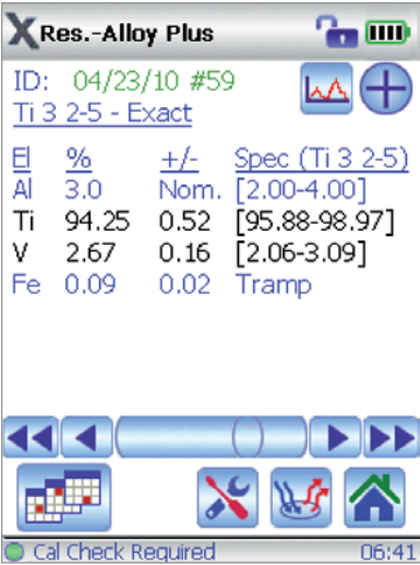
Risultati di analisi con valore nominale (3% Al) e elemento in traccia (0,09% Fe)
