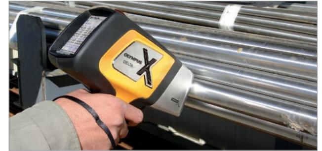
O poderoso analisador portátil por XRF DELTA maximiza a velocidade e a precisão dos testes de ID de ligas e de metais, do controle e da garantia de qualidade, da prevenção e da manutenção.
