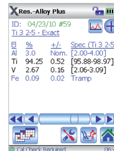
Результаты анализа, отображающие номинальное значение (3% Al) и примеси (0,09 % Fe).
