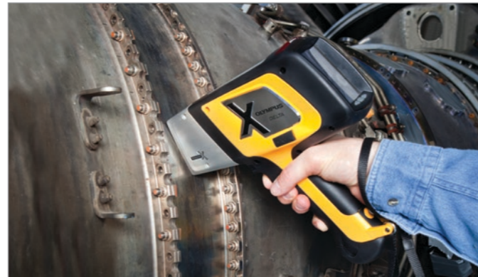
Сходимость с хим. анализом по фосфору (P) в низколегированной стали с помощью анализатора DELTA Premium SDD
