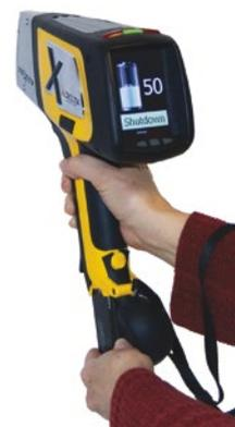
Mit der einzigartigen DELTA Ladestation brauchen Sie das Gerät nie auszuschalten. Die Station lädt sowohl den Akku des Analysergeräts als auch einen Reserveakku und überprüft regelmäßig die Kalibrierung. Durch Hot-Swapping können die DELTA-Geräte vor Ort rund um die Uhr eingesetzt und der Akku bei laufendem Gerät gewechselt werden.
