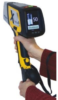
La base de carga DELTA permite mantener el analizador encendido sin tener que preocuparse en apagarlo. Ésta carga la batería del analizador y reduce su consumo para realizar verif. de calibración periódicas. Los analizadores DELTA pueden mantenerse en operación todo el día, en una inspección de campo, gracias al reemplazo de la batería en el modo «Inter. en caliente».
