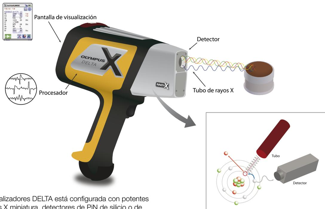
La serie de analizadores DELTA está configurada con potentes tubos de rayos X miniatura, detectores de PiN de silicio o de deriva de silicio (SDD), filtros especializados, y un sistema de optimización de múltiples haces para análisis de campo por XRF más detallados.
