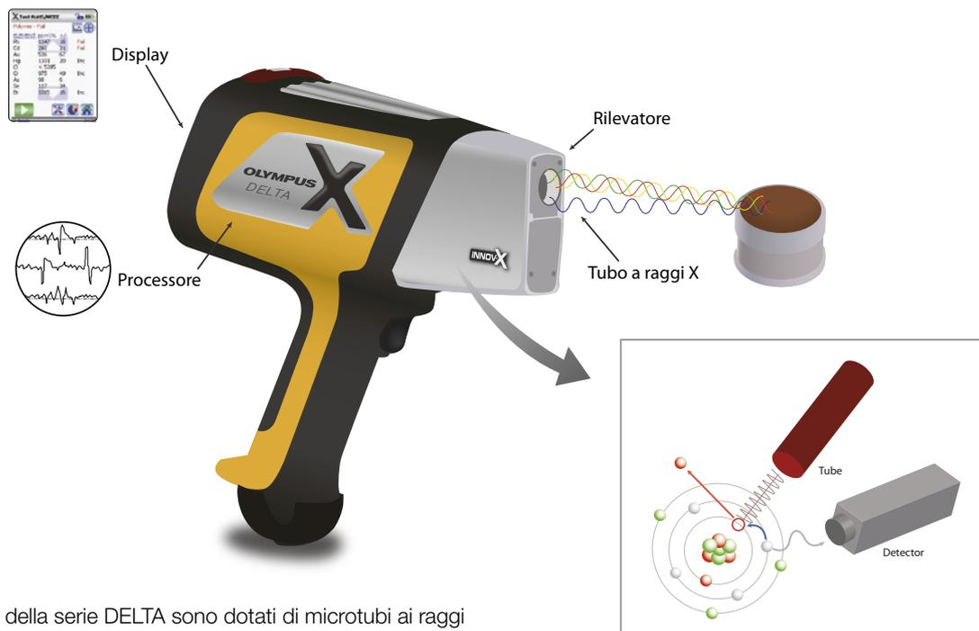
Gli analizzatori della serie DELTA sono dotati di microtubi ai raggi X, rivelatori Si-PIN o rivelatori SDD, filtri speciali e fasci multipli ottimizzati per le più recenti analisi XRF da effettuare sul campo.
