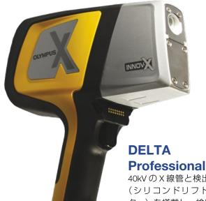
40kVのX線管と検出器にSDD(シリコンドリフトディテクター)を搭載し、検出時間、検出感度、対応可能な元素の数に優れた性能をもつハンドヘルド蛍光X線分析計のベストバリューモデルです。
