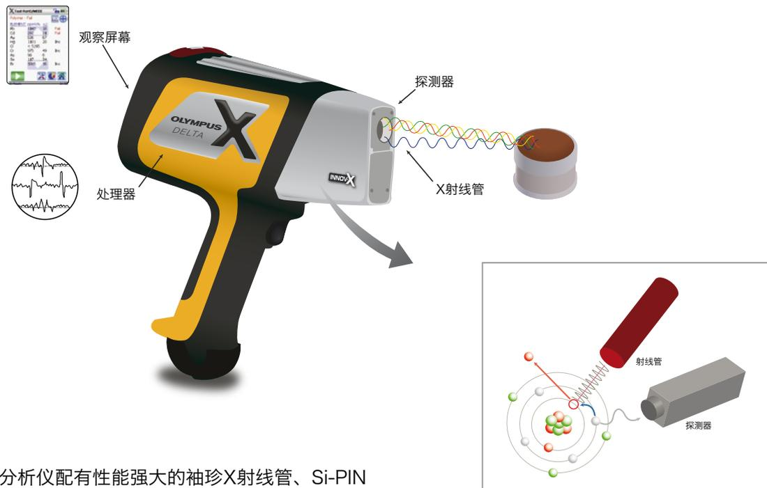
DELTA系列分析仪配有性能强大的袖珍X射线管、Si-PIN探测器或高级硅漂移探测器（SDD）、专用过滤器及多光束优化功能，从而可将XRF的分析性能发挥到极致。
