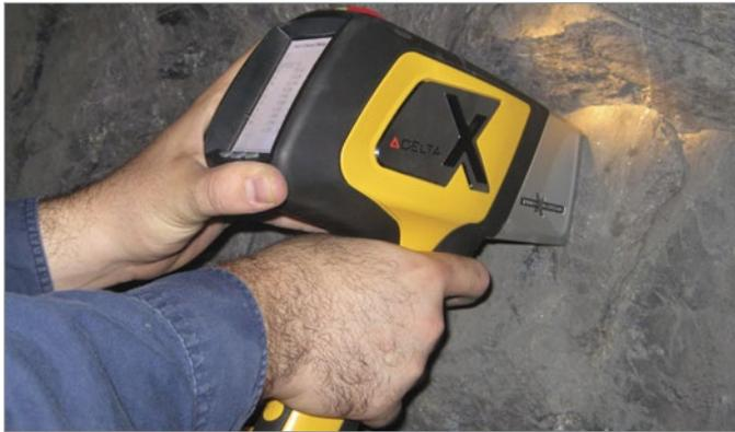
Das DELTA zur Analyse des Elementgehalts
