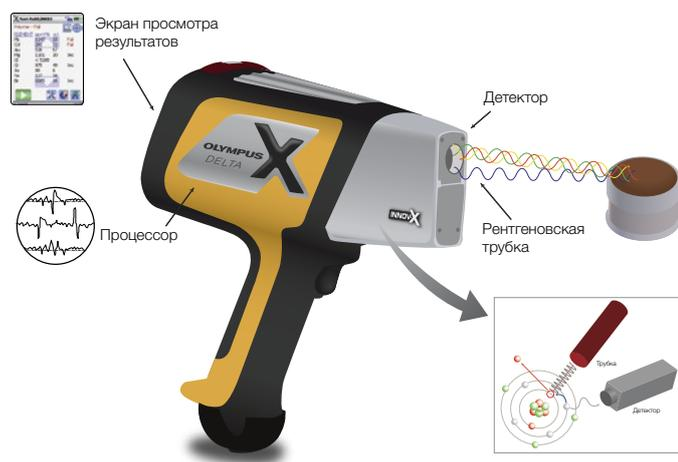
DELTA - это высокоточные портативные рентгенофлуоресцентные (XRF) анализаторы. Прочные и компактные приборы с усовершенствованной технологией скоростного анализа сокращают время исследования, позволяя уверенно выполнять сотни тестов в день.
