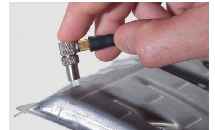
Messen von Metall der durch Biegen oder Formen verursachten Dickenabnahme
