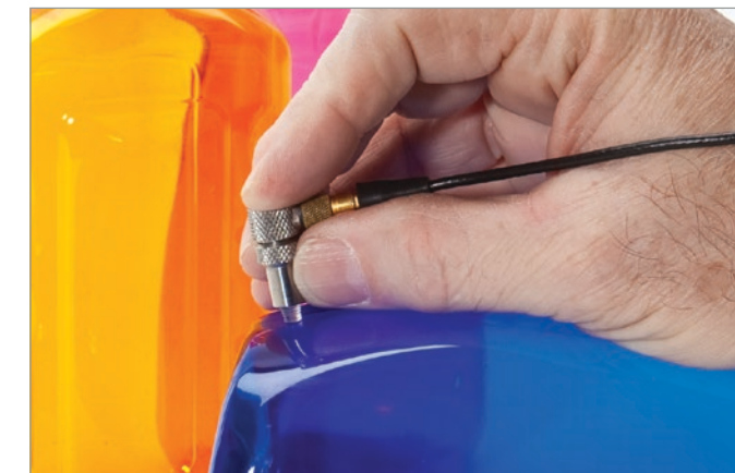
Messen von dünnem Kunststoff mit Vorlaufstreckenmesskopf mit Frequenz von 20 MHz
