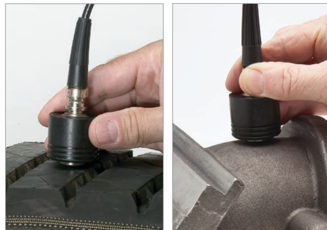
Messen der Tiefe bis zur Cord- oder Stahlkarkasse von Förderbändern oder Reifen
