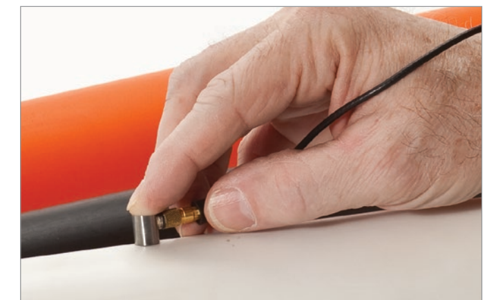
Messen der Dicke von vielen Werkstoffen, wie Kunststoff, Metall, Kautschuk, Glas, Keramik und Verbundwerkstoffe
