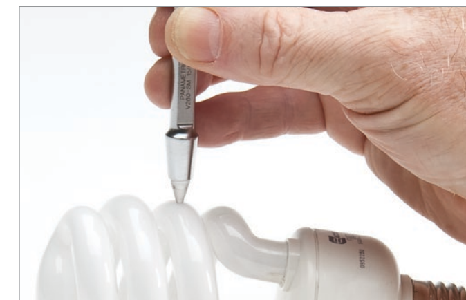
Messen von dünnem Glas mit dem Sonopen Messkopf V260-SM
