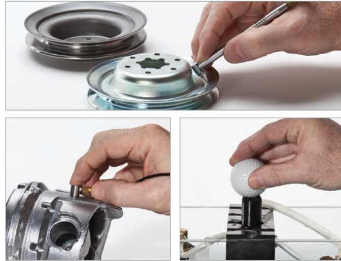
Ultraschallmessungen sind genau, zuverlässig und reproduzierbar. Messwerte können sofort abgelesen werden, auch bei Messungen von nur einer Seite. Das Aufschneiden und Zerstören des Prüfteils ist nicht notwendig.
