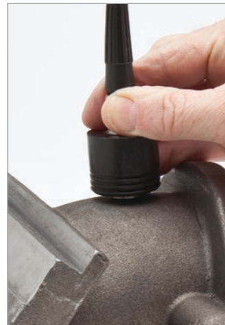
Piezas de fundición o materiales altamente atenuantes pueden ser medidos en su mayoría con la opción software de Alta penetración.
