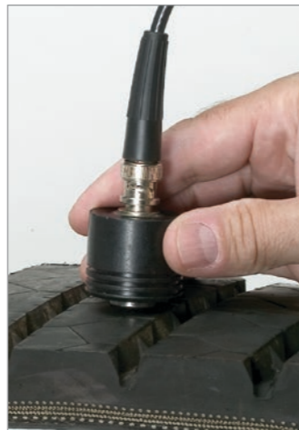
Medición de la profundidad hasta las bandas de tela con cordones de acero en bandas transportadoras o neumáticos de goma.
