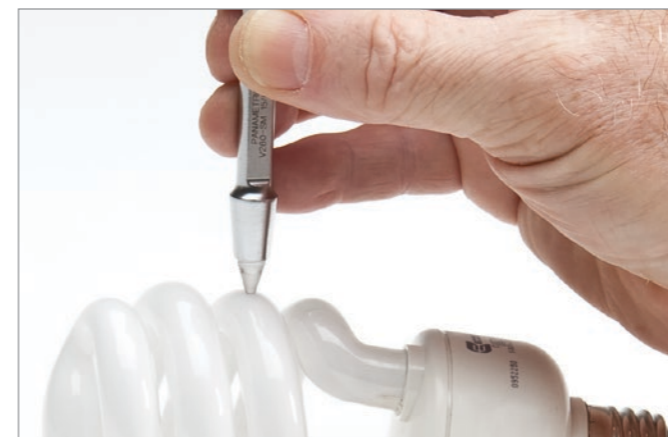
Medición de capas delgadas de vidrio con la sonda Sonopen® V260-SM.
