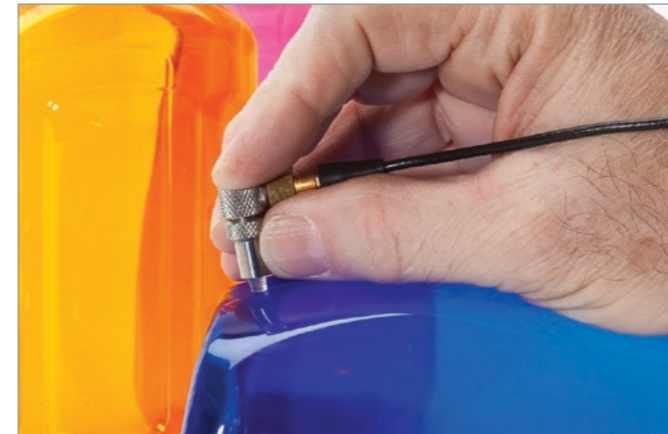
Medición de materiales de plástico delgados con la sonda de línea de retardo de 20 MHz.
