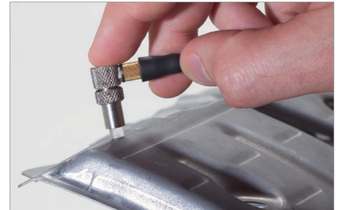
Medición de metales delgados formados por flexión o por modelado.
