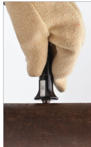
Palpador (o sonda) D790-SM sobre tubo, bajo condiciones de alta temperatura
