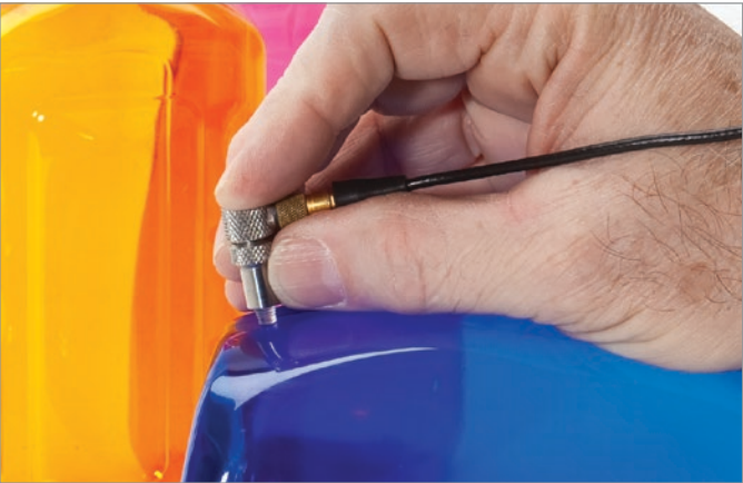
使用20 MHz延迟块探头测量薄塑料材料
