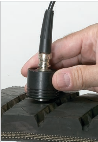
测量橡胶传送带或轮胎中的钢丝帘线的深度
