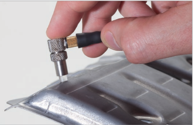
测量金属板因弯曲变形而变薄的情况
