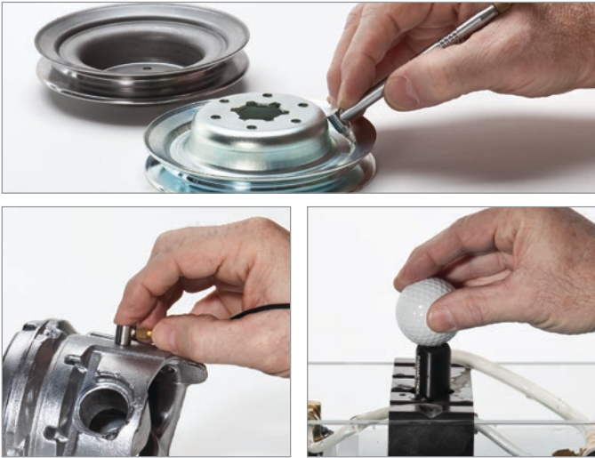
利用超声技术测得的厚度值精确、可靠，并具有可重复性。从材料一侧进行测量即可马上得到厚度读数，因此无需因切开工件而对工件造成毁坏。
