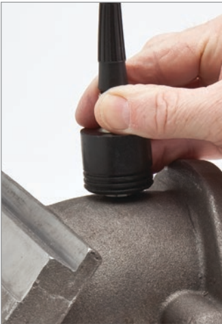
高穿透软件选项可以对很多铸造金属部件及声波衰减性很强的材料进行测量
