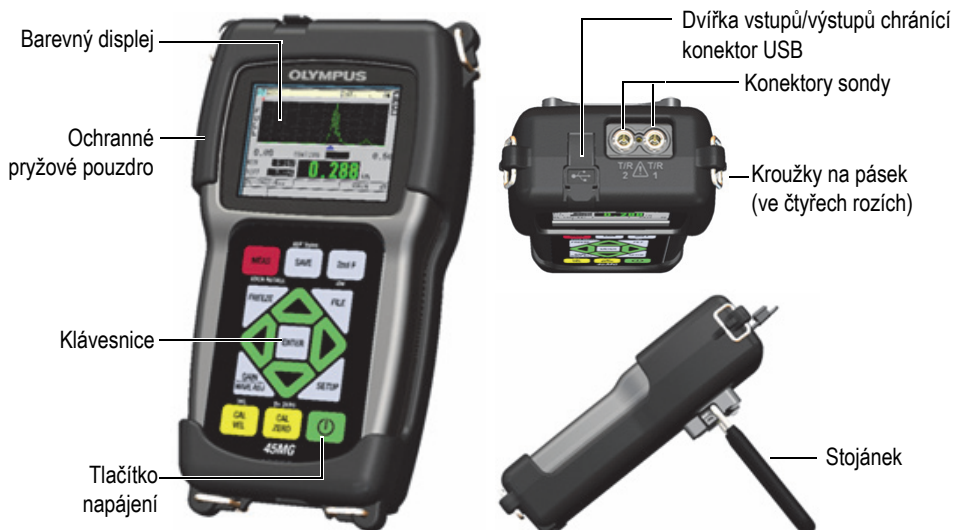
Obrázek 1-1 Hardwarové součásti přístroje 45MG – pohledy zepředu, shora a z boku
