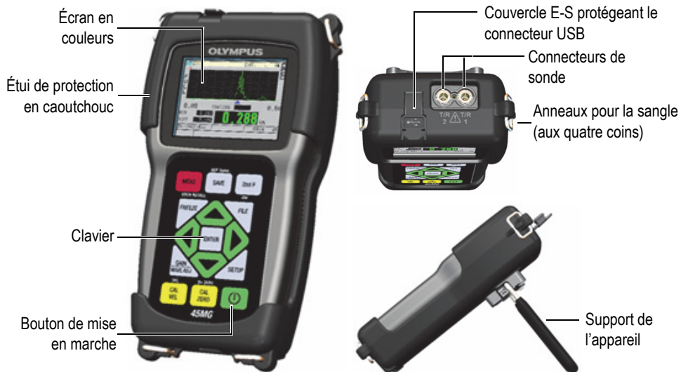
Figure 1-1 Composants matériels du 45MG – Devant, dessus et côtés
