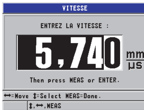
Figure 5-9 Entrée de la vitesse de propagation connue des ondes ultrasonores dans le matériau
