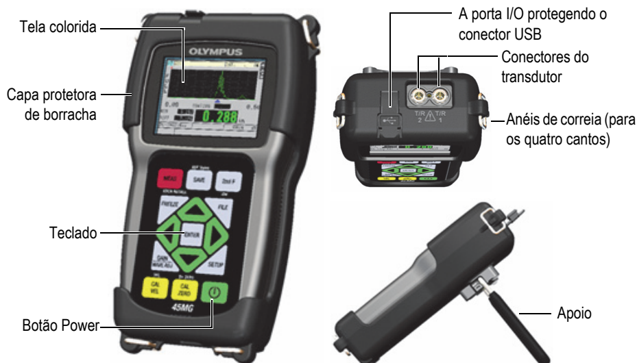
Figura 1-1 Componentes do hardware do 45MG — Visualizações da parte frontal, superior e lateral
