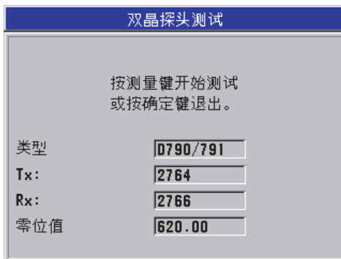
图 12-3 双晶探头测试屏幕
