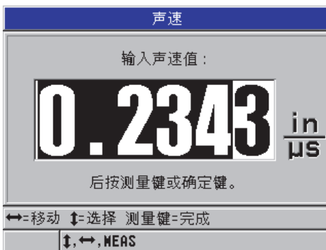
图 5-9 输入一个已知材料声速
