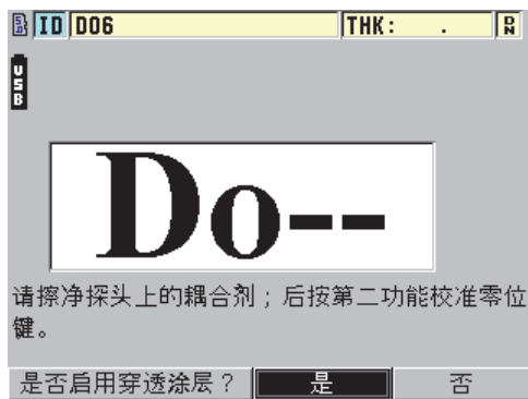
图 6-6 打开穿透涂层设置对话框
