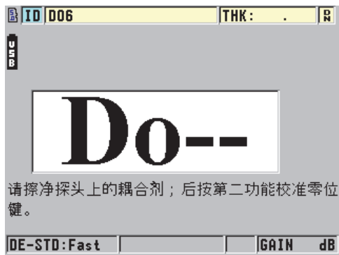
图 5-2 使用标准 D79X 双晶探头的初始屏幕
