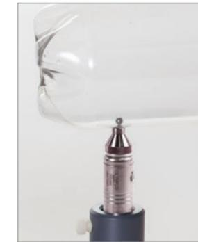
En las mediciones de estas piezas, tales como los recipientes de plástico, necesita tan solo colocar la esfera dentro del recipiente. La sonda magnética, colocada al exterior de la pieza, atraerá dicha esfera. Esta última sigue el recorrido de la sonda hasta en las inspecciones de superficies o esquinas de geometría
