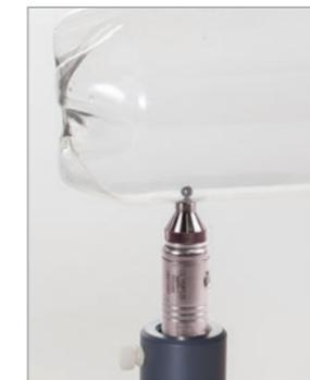
In applicazioni per la misura di contenitori in plastica, inserire semplicemente il target a sfera di ridotte dimensioni all'interno del contenitore. La sonda magnetica posizionata all'esterno del contenitore calamita il target a sfera. Il target a sfera in acciaio si sposta all'unisono con la sonda durante la scansione di superfici e angoli. Mediante
