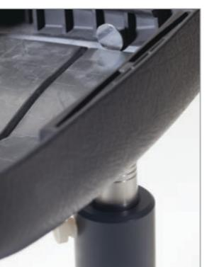
Magna-Mike 8600测厚仪在与标准探头、两个目标圆盘中的一个圆盘，及一个可替换凿尖型防磨端配套使用时，可以非常好地适用于大多数汽车撕裂接缝的检测应用，因为这类测量需要在细小的通道或凹槽中进行。
