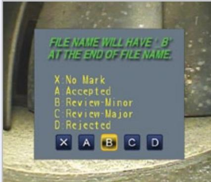
InHelp puede almacenar imágenes en carpetas dedicadas a una parte de la inspección. Puede navegar de una parte de la inspección a la siguiente con solo pulsar una tecla. Éste es un modo eficaz de gestionar las imágenes y agilizar el flujo de trabajo. Para obtener aún más eficiencia, un mensaje en pantalla le permite agregar comentarios y diagnósticos de defectos a cada imagen.
