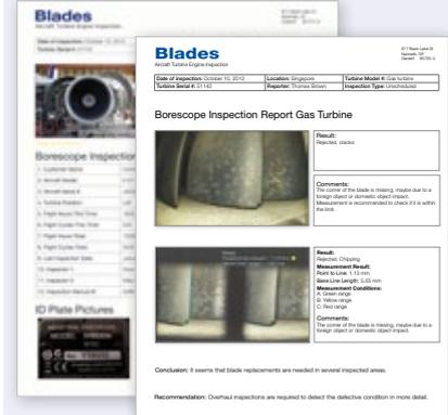
InHelp puede crear un informe de inspección pormenorizado simplemente seleccionando las imágenes con una sola pulsación. Olympus puede elaborar plantillas de informes personalizadas adaptadas a las necesidades de cada Turbina cliente. Puede utilizar plantillas optimizadas según sus necesidades e incorporar información propia, como un manual de inspección.
