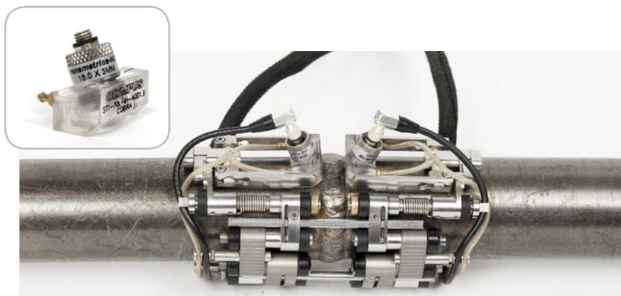
Der COBRA-Rohrscanner kann die TOFD-Prüfung mit geeigneten Vorlaufkeilen, Kabeln und Schallköpfen an Rohren mit kleinem Durchmesser durchführen.
