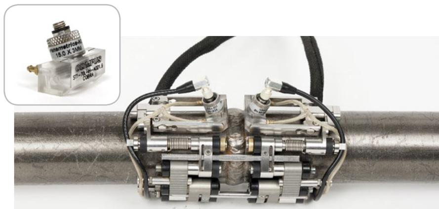
Le scanner COBRA pour les tuyaux de diamètre restreint peut effectuer des inspections TOFD à l'aide de sabots, de câbles et de sondes appropriés.
